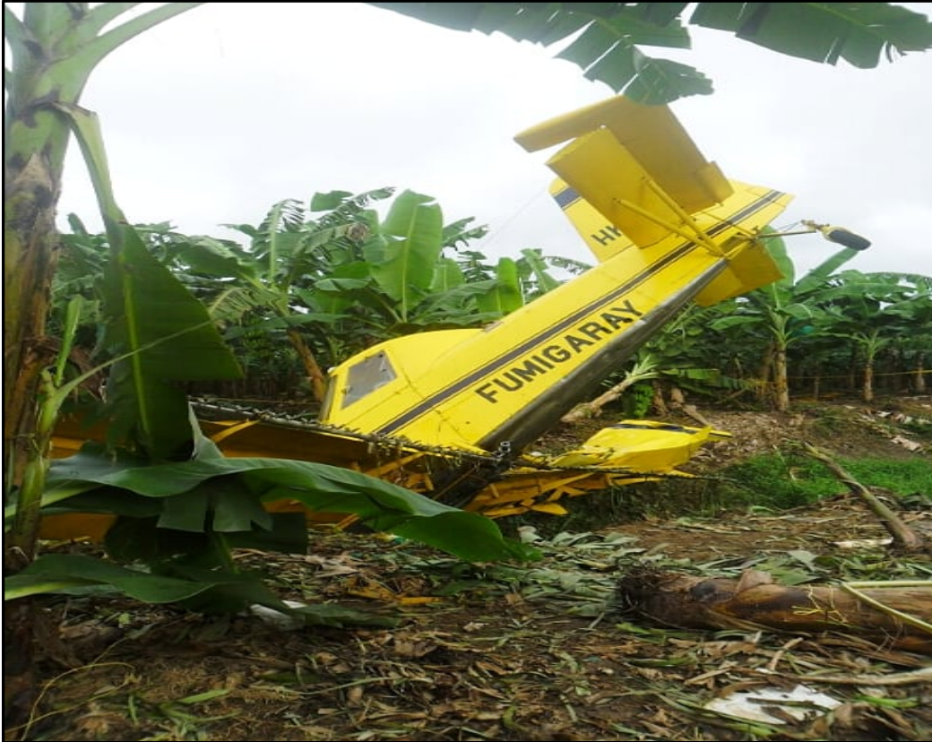
Fotografía No. 2: Daños en las superficies de control.
