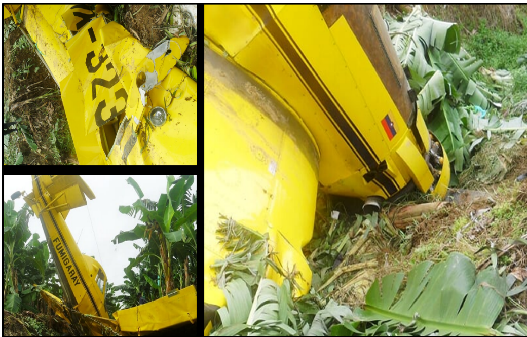
Fotografía No. 3: Daños en los planos y la planta motriz.
