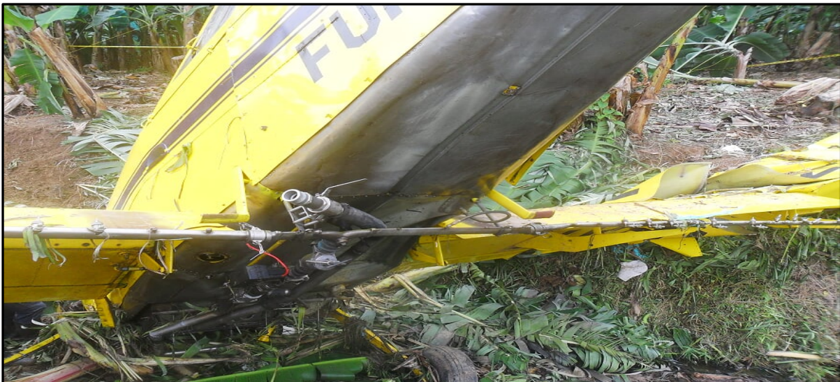
Fotografía No. 4 – Daños en el fuselaje y en el sistema de aspersión
